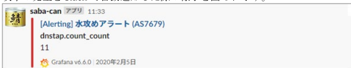
図 4. 攻撃検知システムからの自動通知の様子
